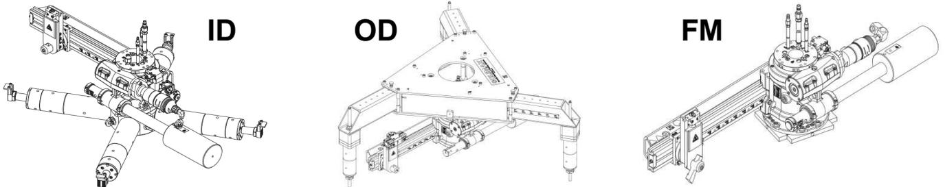
Cualquier superficie circular (anillo, disco, etc.) es considerado como si fuera una brida, consecuentemente, aplican los mismos conceptos para las refrentadoras como para las fresadoras circulares. Cuando la herramienta corta del horizonte para arriba es “sobrecabeza”.
